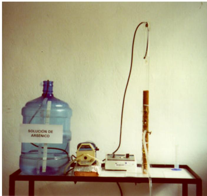
**Figura 1. Adsorción en línea con un lecho de zeolita recubierta de óxidos de hierro**
